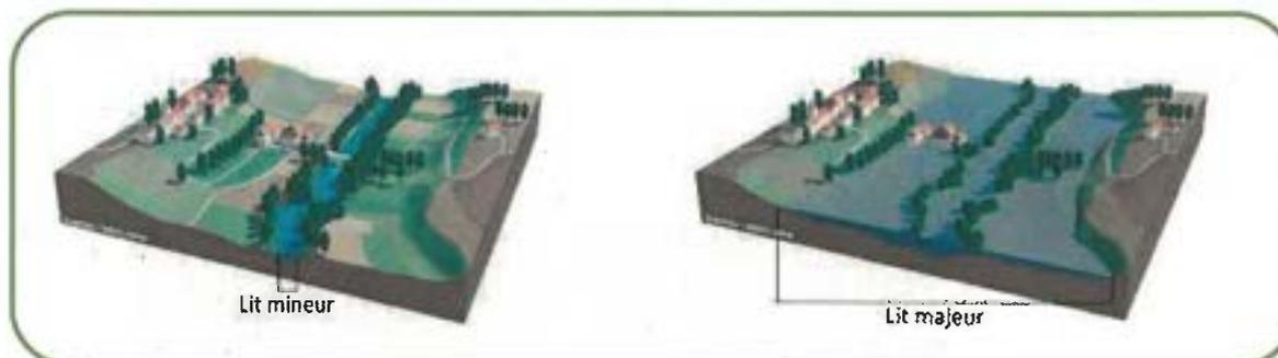
De telles crues sont provoquées par des pluies prolongées qui tombent sur des reliefs peu marqués aux sols assez perméables où le ruissellement est long à se déclencher (grandes superficies des bassins versants, plusieurs dizaines de milliers de km<sup>2</sup>, et faibles pentes). Le temps nécessaire à l'eau tombée pour rejoindre le cours d'eau principal est donc important et il ne peut s'agir, contrairement aux torrents, de la répercussion d'épisodes orageux violents et localisés.
